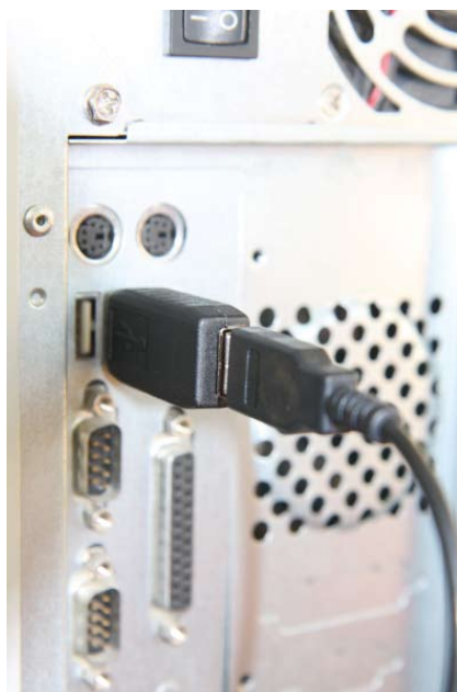
Figuur 7. Keylogger die alle toetsaanslagen verzamelt.
