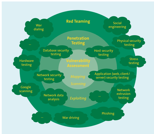
Figuur 1. Red teaming, testmethode waarbij verschillende aanvalstechnieken gecombineerd worden om een daadwerkelijke aanval te simuleren.
