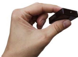
Figuur 6. 'Audiobug' waarmee via GSM gesprekken kunnen worden afgeluisterd.
