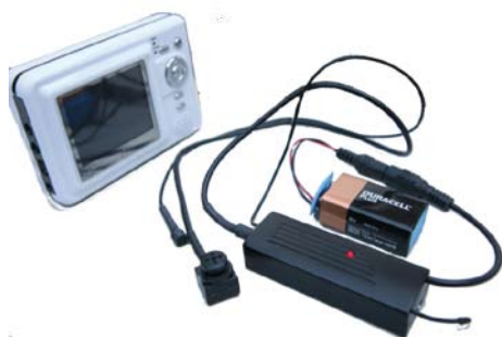
Figuur 4. Een 'knoocamera' waarmee ongemerkt bijvoorbeeld toetsaanslagen gefilmd kunnen worden.
